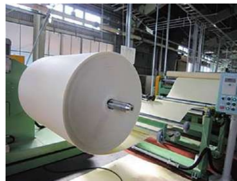
発泡素材を加工し、保温材用シートの原反を作っています
