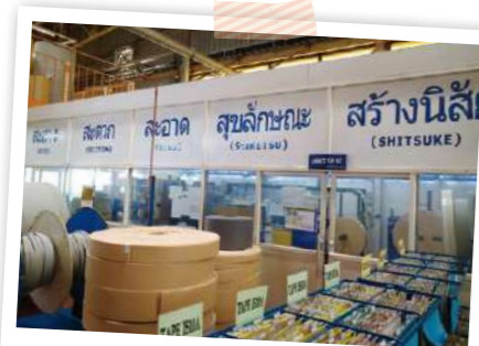
タイの工場でも、日本と同じく「5S(整理・整頓・清掃・清潔・しつけ)」が徹底されています。
