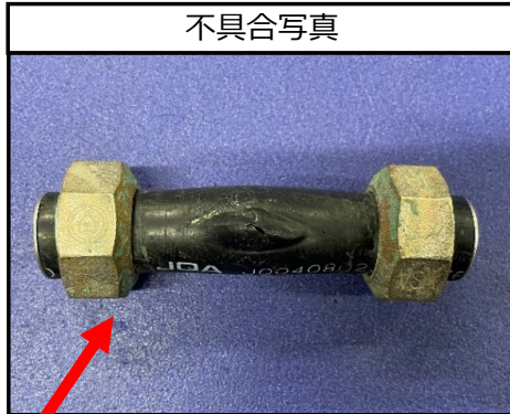
1月(真冬)に埋設部分で破裂
