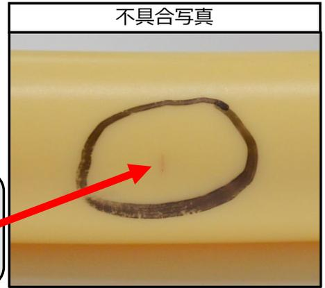
継手接続部からすぐの曲げ配管をすると、曲げRの外周部に強い負荷が掛かり、亀裂漏水事故が生じる恐れがあります。
