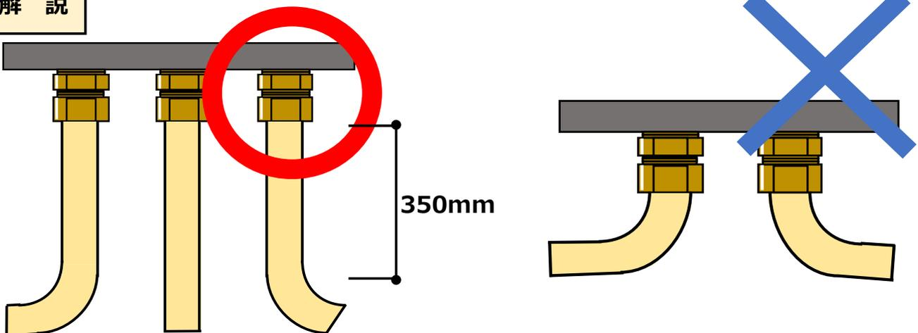
継手接続部からすぐの曲げ配管はせず、必ず、ストレート部を350mm以上確保してください。CDサポート等固定具すぐの曲げ配管も同様です。
