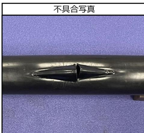
写真のように、破裂部位が膨らみ破壊することを延性破壊といいます。一般的に、管の耐圧性能を超えた過剰な圧力を掛けた時に見られる破壊形態です。
