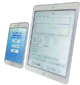
BluetoothでデータをiPhone、iPadに送信し、専用アプリで現場写真と併せて管理
