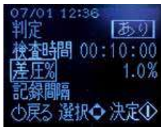
配管メーカー指定基準・社内基準に沿った圧力試験を任意に設定して合否を表示
