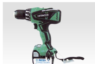
電動ドリル ※インパクトドリルは使用しないでください
